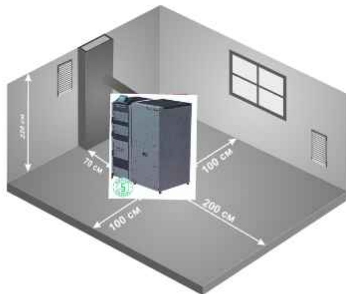
рис. 8.1. Мінімальні відстані при установці котла в котельні
