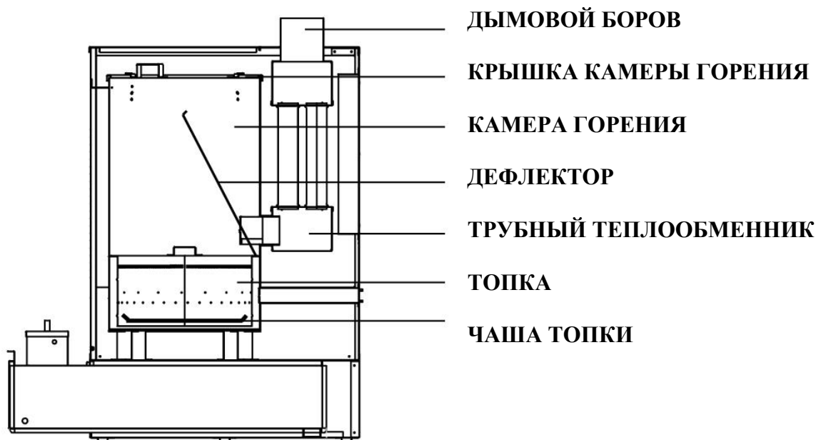
Рис. 3. Конструкция камеры горения
