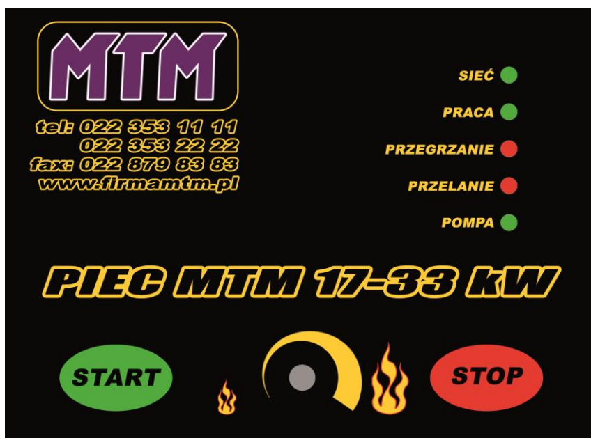
Рис. 4. Вид переднего пульта модуля управления нагревателя на универсальном масле.
